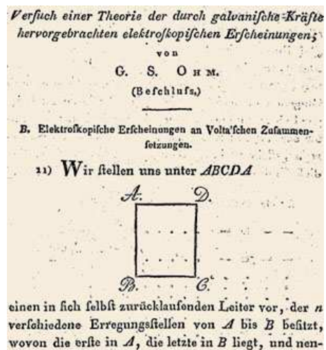
Fig. 6. La représentation d'un circuit par Ohm (AB : pile, ADCB : conducteur) [Journal für Chemie und Physik, avril 1826]
