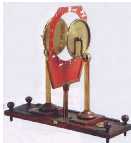
Condensateur d'Aepinus avec armatures métalliques mobiles et plaque de verre amovible (Musée des Arts et Métiers)
