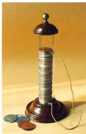
Figure 7-Pile Volta reproduite au musée Ampère
