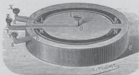
est soudée au centre O du disque à une tige verticale sur laquelle est soudée une quatrième coupe U, dont le fond est garni d'un morceau de verre ou d'agate pour rendre plus mobile le sautoir dont nous allons parler, mais dont les bords sont assez élevés pour être en communication avec le mercure qu'on met dans cette coupe; elle reçoit la pointe V (fig. 11) qui sert de pivot au sau-
