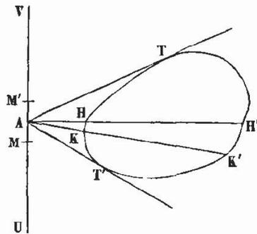
pour plus de simplicité, que le circuit fermé THKT'H' soit dans le même plan que le fil conducteur UV, et cherchons l'action exercée par un élément quelconque MM' de ce dernier. Pour cela,
