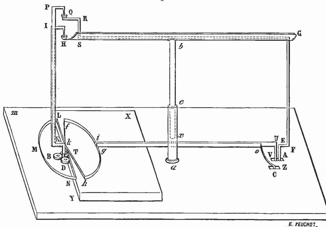
$H$  et  $H'$  où l'on met du mercure. Aux points  $A, C, A', C'$  de la table sont quatre cavités remplies de même de mercure. De  $A$  part un conducteur en cuivre  $AEFGSRQ$ , soutenu par  $HH'$  et terminé par une coupe  $Q$ ; de  $A'$  il en part un second  $A'E'F'G'S'R'Q'$  symétrique au premier; ils sont tous les deux entourés de soie, pour être isolés l'un de l'autre et du conducteur  $HH'$ . Dans la
