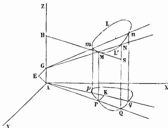
G; abaissons de A une perpendiculaire  $AE = q$  sur le plan du circuit et joignons EG. Soit  $Apq$  la trace d'un plan infiniment voisin du premier, faisant avec celui-ci un angle  $d\varphi$ ; faisons  $AP = u$  et  $PQ = \delta u$ . L'action du circuit sur l'élément en A dépend, comme nous l'avons vu, de trois intégrales désignées par A, B, C, que nous allons calculer. Considérons d'abord C, dont la valeur est
