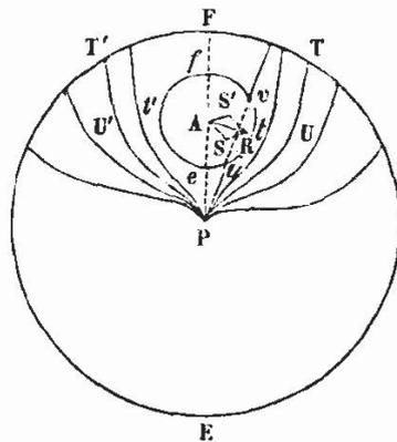
verre plein de mercure en contact avec un cercle de cuivre qui en garnit le bord intérieur et qui communique avec un des rhéophores, le rhéophore négatif par exemple, tandis que l'on y fait plonger en P le rhéophore positif; alors il se forme dans le mercure des courants qui vont du centre P du cercle ETFT' à sa circonférence.
