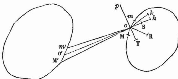
ment de la première courbe,  $ds' = M'm'$  un élément de la seconde;  $x, y, z$  et  $x', y', z'$  les coordonnées de leurs milieux  $o, o'$ , et  $r$  la droite  $oo'$  qui les joint, laquelle doit être considérée comme une fonction des deux variables indépendantes  $s$  et  $s'$  qui représentent les arcs des deux courbes comptés à partir de deux points fixes pris sur elles. L'action mutuelle des deux éléments  $ds, ds'$  est, comme nous l'avons vu plus haut, une force dirigée suivant la
