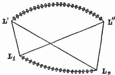
agissent l'un sur l'autre, il y a quatre forces dirigées respectivement suivant les droites  $L'L_1$ ,  $L'L_2$ ,  $L''L_1$ ,  $L''L_2$  qui joignent leurs extrémités deux à deux; et si, par exemple, il y a répulsion suivant  $L'L_1$ , il y aura attraction suivant  $L'L_2$  et  $L''L_1$ , et répulsion suivant  $L''L_2$ .
